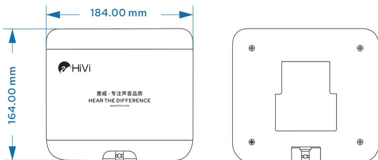
🔔温馨提示：要获得最佳效果，应将天线悬挂在天花板上，天线直接对着目的覆盖范围，这能够确保获得最佳的接收效果，并大幅度降低信号衰减的可能性。
