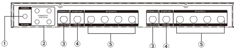
①直流电源输入接口12V/5A
